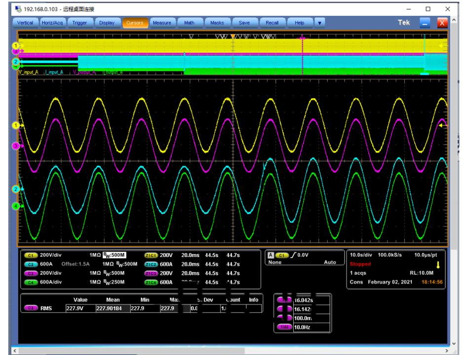
Стабильное напряжение на выходе ИБП
